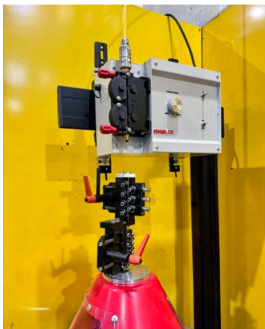
Hochwertige Schweißtechnik: Drahtrichtgerät RoboStraight mit RoboFeed und Duroliner-Drahtförderschlauch von Migal.Co.
