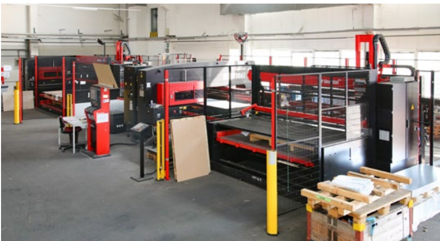
Die Stanzmaschinen der AE-Baureihe vereinen bewährte Maschinenkomponenten wie den Amada-Brückenrahmen mit servoelektrischer Antriebstechnologie und bestehen mit hoher Präzision sowie Energieeffizienz.
