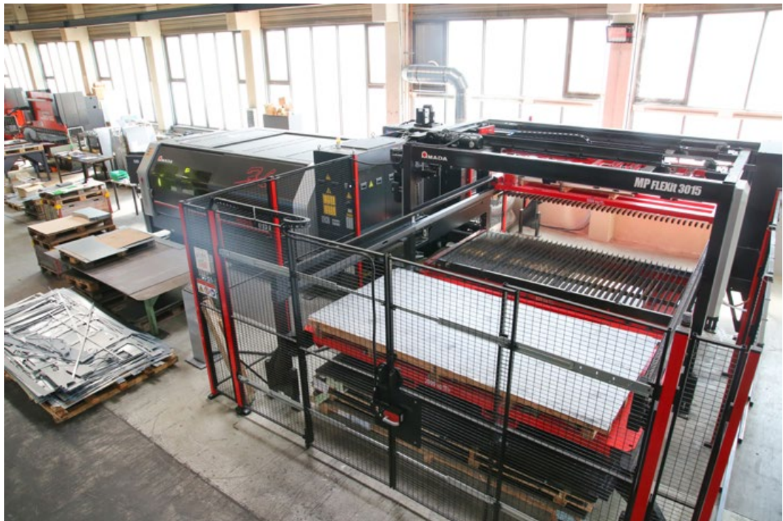
Für einen kontinuierlichen, automatisierten Betrieb verfügt der Fiberlaser über die kompakte Be- und Entladeeinheit MPF .
