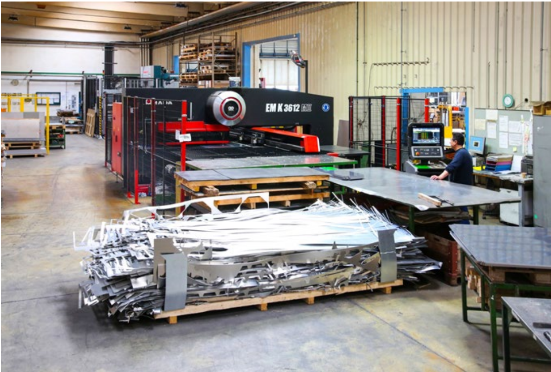
Die Stanzmaschine EM K-3612 MII mit 30 Tonnen Presskraft überzeugt mit geringem Energiebedarf und hoher Stanzgeschwindigkeit bei gleichzeitig hoher Laufruhe.
