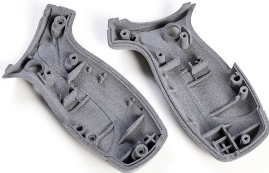
Griff Innenansicht: 3D-gedruckt im MJF-Verfahren mit PA 11, das einzigartige Eigenschaften bietet, die es für verschiedene medizintechnische Anwendungen mit 3D-Druck gut geeignet machen.
