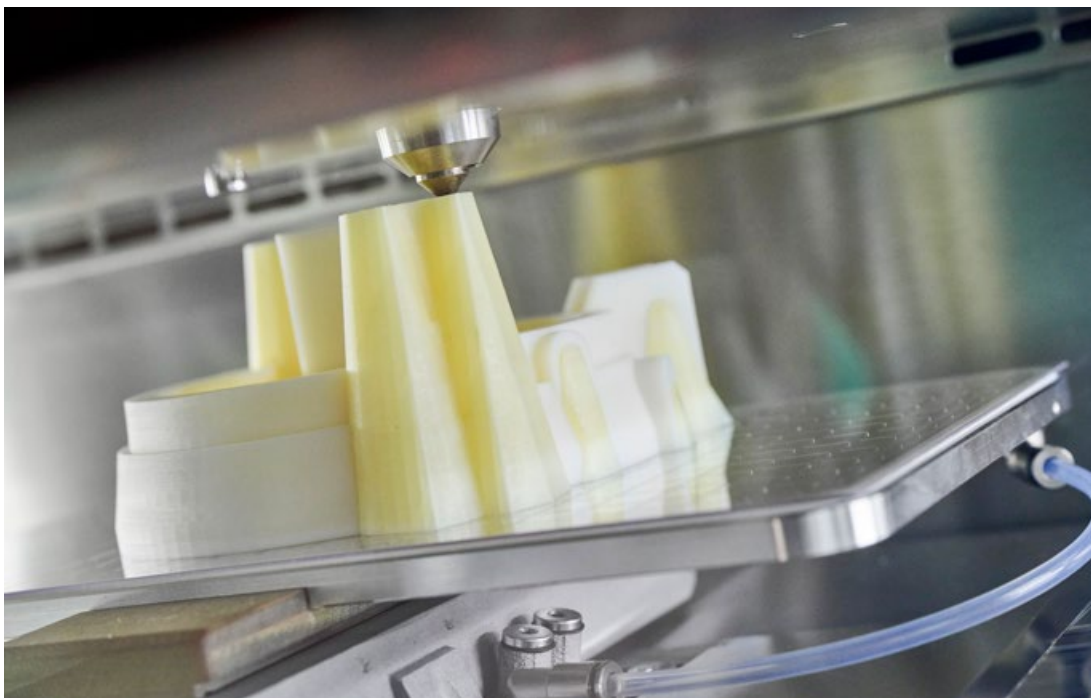
Mit dem Freeformer wurden Greiferelemente in einer Hart-, Weichkombination gedruckt, die in einer Turn-Key-Anwendung auf den Technologietagen gezeigt wurden.
