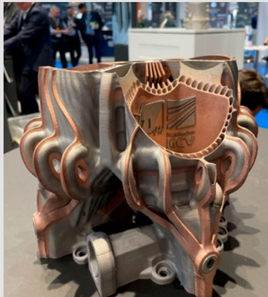
Selbst Multi-material-anwendungen sind mit dem LPBF-Verfahren mittlereweile realisierbar. Die Technologie wird am Fraunhofer IGCV in Augsburg entwickelt.
