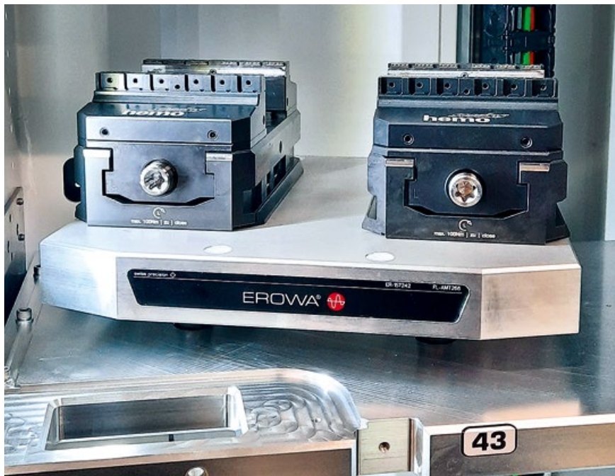
Das Erowa VPC-Spannsystem garantiert kraftvolles und präzises Spannen von Zentrischspannern, Vorrichtungen und Werkstücken mit Stichmaß 52 oder 96 mm.
