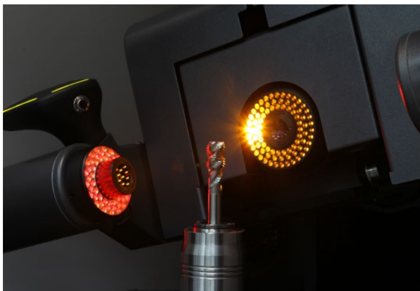
Mit einem Schwenkbereich von -30^\circ bis +30^\circ eliminiert orthoScan steigungsbedingte Verzerrungen bei der Messung von Gewindewerkzeugen.
