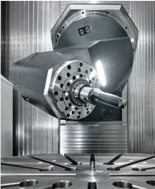
Die grundlegend überarbeiteten Schwenkköpfe mit integrierten und eigens von Heller entwickelten Motorspindeln tragen wesentlich zur hohen Genauigkeit und Dynamik der F 6000 bei.
