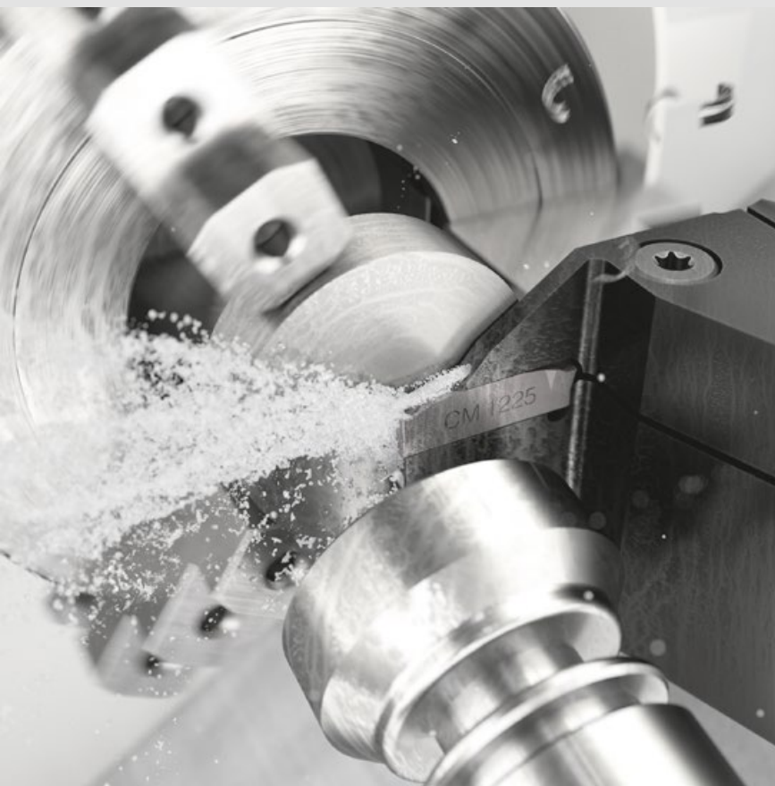
CM-Geometrie CoroCut 2: Erste Wahl zum Abstechen zur Mitte bei guten Bedingungen in den meisten Werkstoffen sowie leichten Schnittunterbrechungen wie Abstechen von Mehrkantmaterial.
