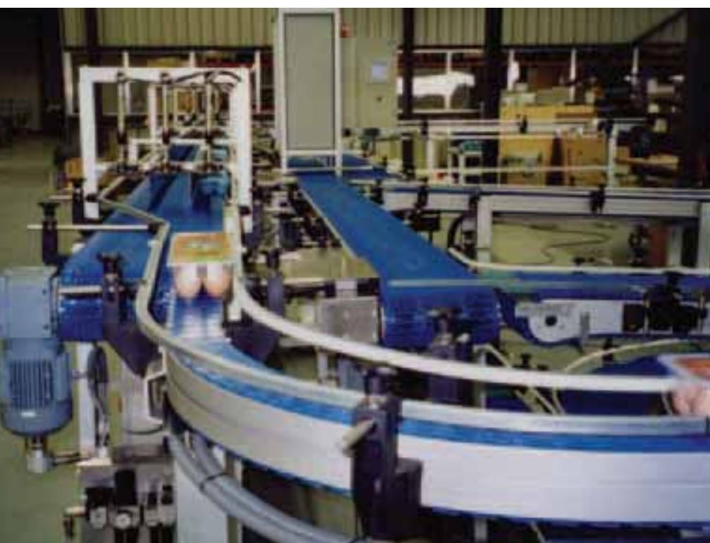
Bild 1: Blick auf die Förderanlage für verpackte Roheier, gegen die Förderrichtung gesehen.
