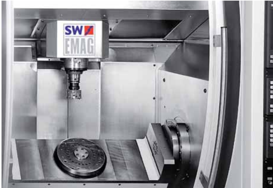
Rundum komplett: Mit direkt in die Spannbrücken integrierten Rundtischen als fünfte NC-Achse lassen sich Bauteile in einer Aufspannung komplett bearbeiten.
