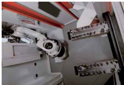
Roboterzelle von oben mit Palettenmagazin, schräg angeordneter Roboter beim Beladen.
