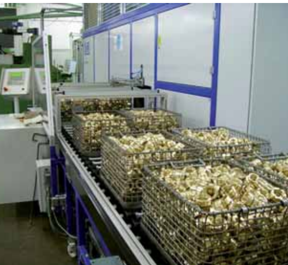
Die Zuführung der Teile erfolgt über eine Rollenbahn. Pufferstrecken gewährleisten, dass der Reinigungsbetrieb während Arbeitspausen mannos weiterlaufen kann.
