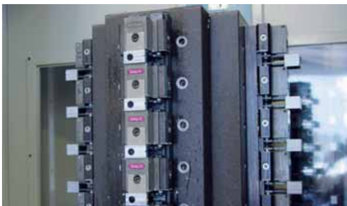
powerCLAMP im Einsatz als Mehrfachspannstock.
