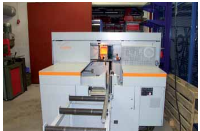
Die Zufuhrseite der KASTotwin A2 mit dem von einer Kugelrollspindel angetriebenen Materialvorschub.
