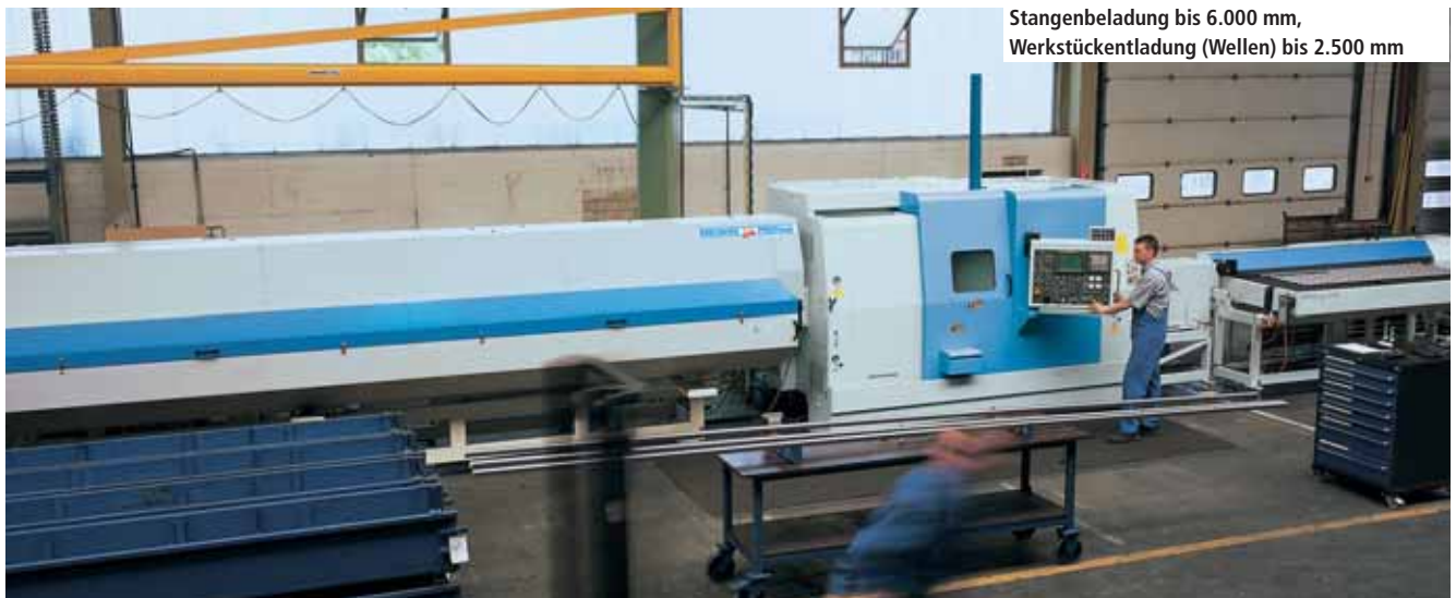
Hochleistungs-Drehzelle für das automatisierte Präzisionsdrehen von langen Werkstoffstangen
