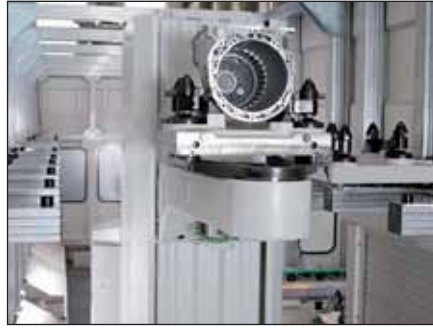
Optimale Werkstücklogistik - integrierter Werkstückspeicher in Parallelanordnung entlang des Fahrwegs.
