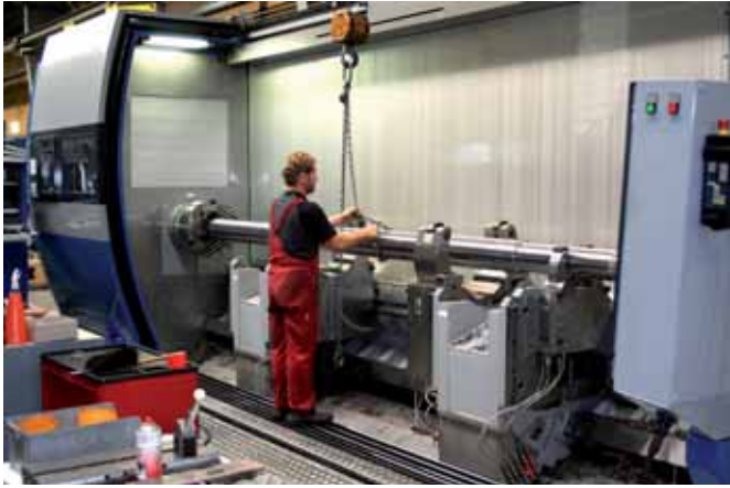
Die spezielle Ergonomie der Maschine ermöglicht einen einfachen und sicheren Zugang zum Werkstück.
