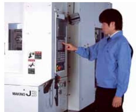
Die Software der Automationsperipherie enthält vorgegebene Werkstückabstände. Reale Teile werden via Teach-In programmiert und an der Steuerung feintuned.
