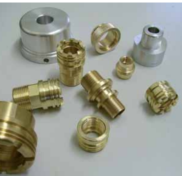
2.000 Tonnen Messing und 28,5 Tonnen Aluminium verarbeitet aquatherm-metall jährlich zu Gewinde-Einspritzteilen von 3/8 bis 4 Zoll.
