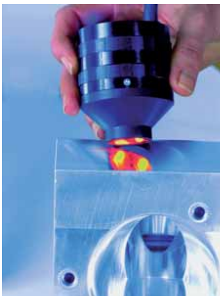
„PartSens“ - Ein Kontroll- und Messsystem für die Erkennung und Quantifizierung partikulärer Verunreinigungen.
