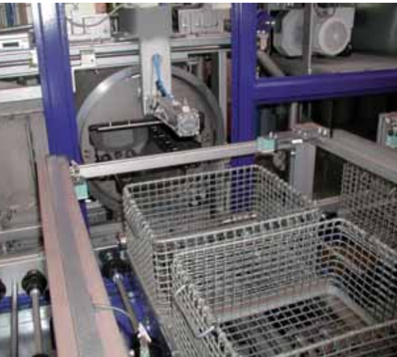
Die Arbeitskammer der neuen Anlage ist für zwei Warenkörbe mit Abmessungen von 465 x 365 x 340 (L x B x H) Millimetern ausgelegt. Das Chargengewicht liegt bei 100 Kilogramm.
