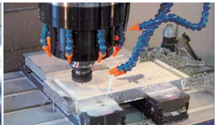
Einzelspannung von Platten; Schraubstockähnliche Spannung (Bearbeitung einseitig).
