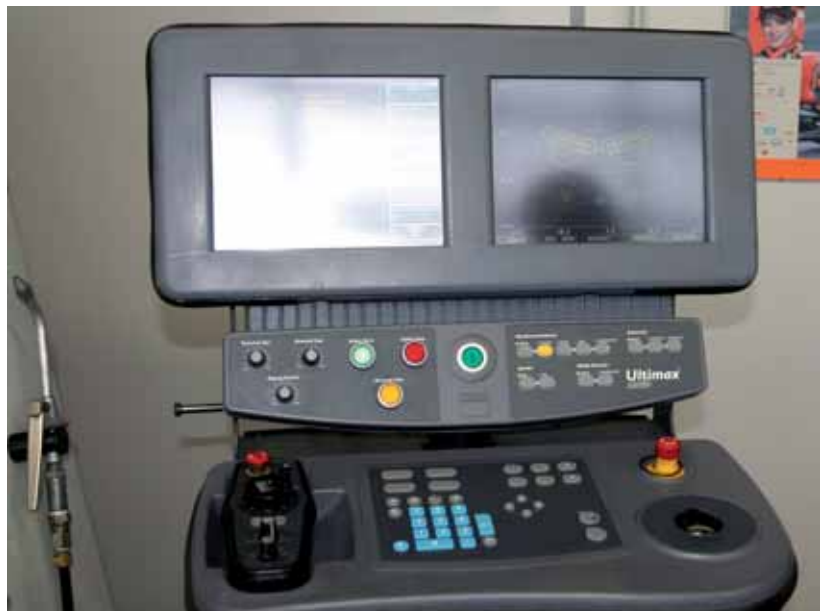
Die Ultimax-Steuerung mit dem Doppel-Bildschirm ist derart bedienerfreundlich, dass sich ein Maschinenbediener schnellstmöglich einarbeiten kann. (Bild: x-technik)
