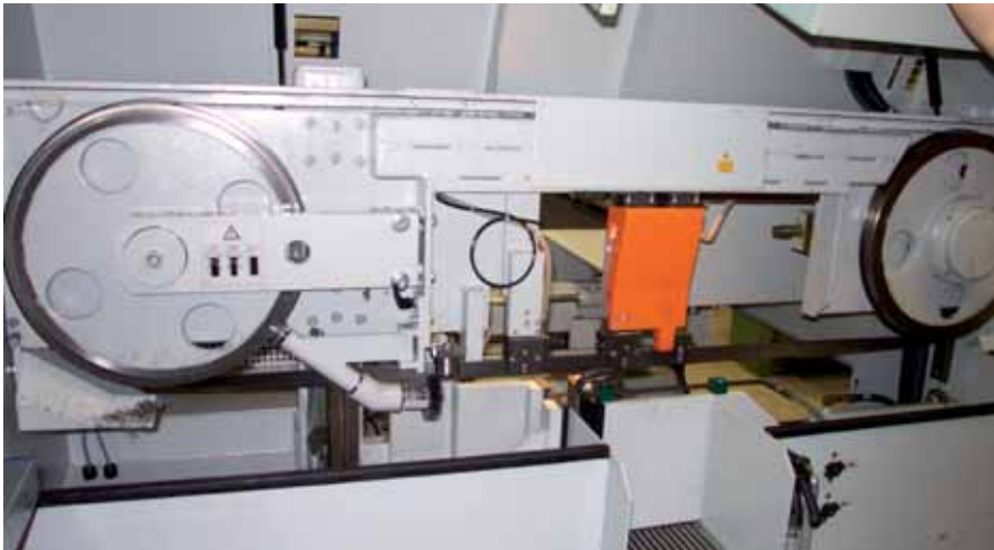
Die gut zugängliche Sägeeinheit der KASTOtwinn A 2 nach Aufschwenken der Schutzhaube.
