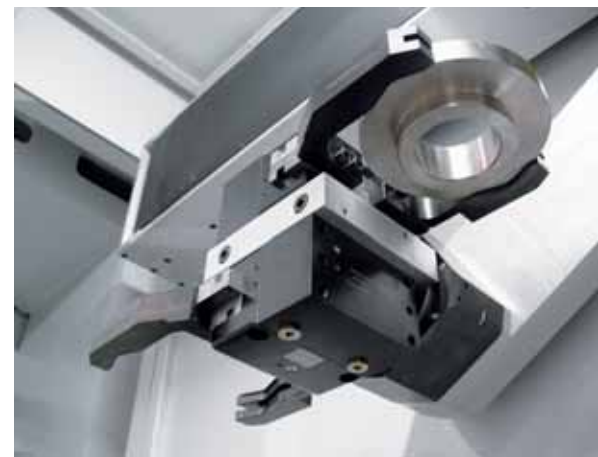
Die S 250 G ist mit einem modularen Portallader ausgerüstet.
