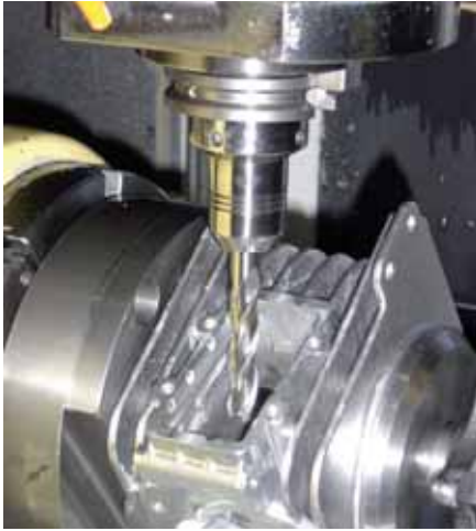
Schlichtfräsen des Untergehäuses eines Kart-Motors aus hochfester Aluminium-Gusslegierung.
