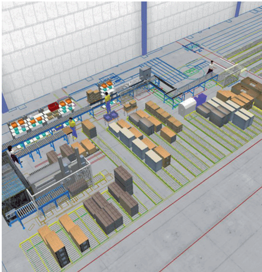
Die neue Version 8.0 der Software taraVRbuilder dient zur realitätsnahen Abbildung und detailgetreuen Analyse von Logistikprozessen.
