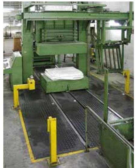
Sicherheitskontaktmatten im Einsatz an einem Presswerk.
