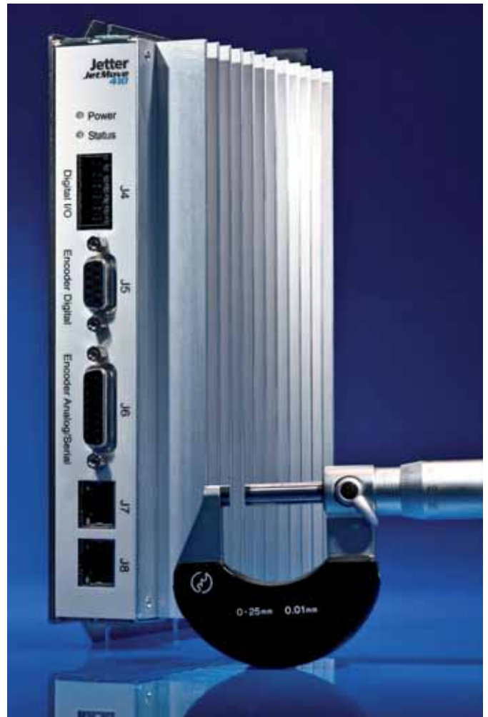
Die Regler der JetMove 400 Familie sind für Anwendungen mit höchster Präzision und größter Dynamik – bei Genauigkeiten im Nanometerbereich mit Beschleunigungen größer 20 m/s 2 .
