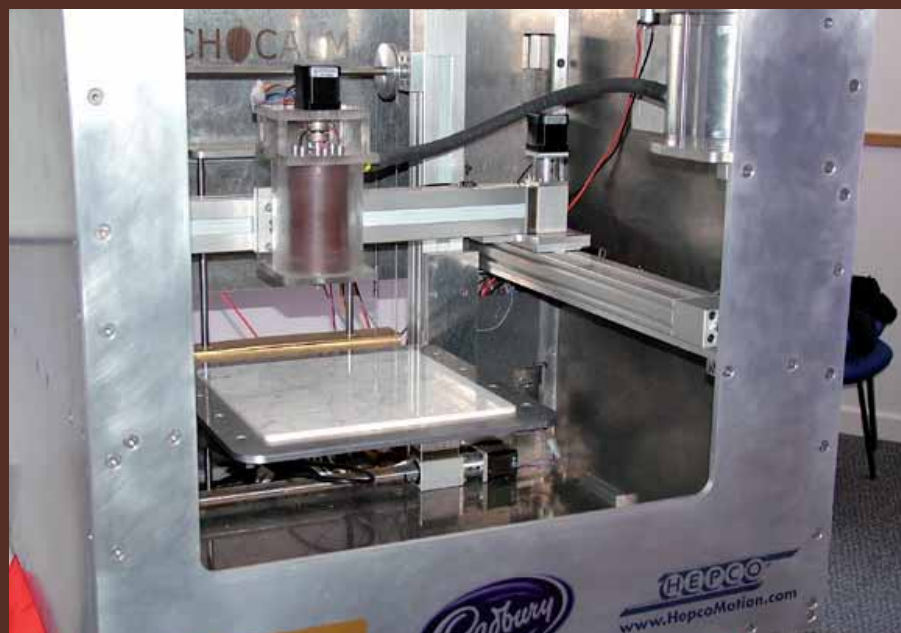
ChocALM vermag mithilfe von Computerdaten ein beliebiges 3D-Schokoladenobjekt herzustellen.
