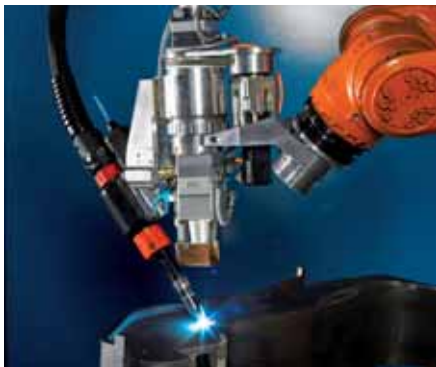
Neuentwickelter Laser-Hybrid-Schweißkopf mit integrierter siebter Roboterachse im flexiblen Hochleistungseinsatz an dickwandigen Stahlteilen.
