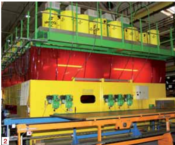
1 Auf einer großen Bühne oberhalb der Fertigungszelle sind die Schaltschränke, die Impulsstromquellen und die Drahtfässer raumsparend platziert.
