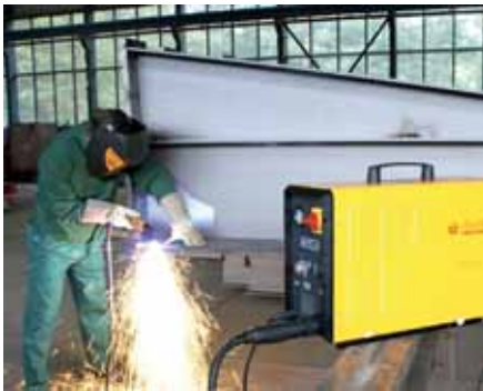
Bis 50 mm Materialstärke flexibel und mobil mit Plasma schneiden, das ermöglicht der Inverter CUTi 120.
