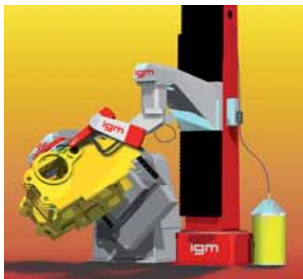
Roboteranlage mit Hubsäulenkonzept
