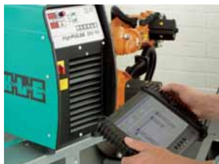
Fernbedienung und Programmierung über Tablett PC mit WLAN.
