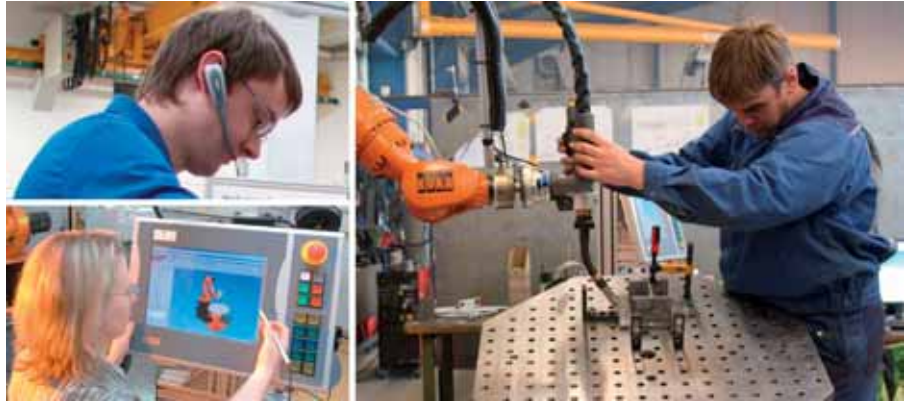
Hauptkomponenten der intuitiv programmierbaren Schweißroboterzelle: Sprachsteuerung (links oben), grafische Bedienerschnittstelle (links unten) und Handführung (rechts).
